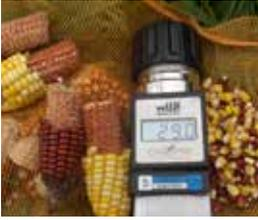
Pour pouvoir contrôler l'humidité des grains, l'achat d'un humidimètre portable peut être un investissement utile.
