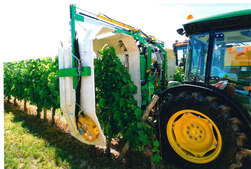
La pulvérisation confinée est une piste pour réduire les doses de cuivre.
