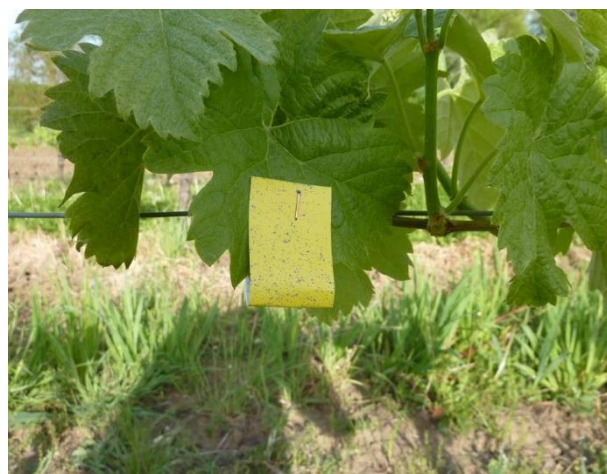
Figure 15 : Photo d'un papier hydrosensible prise lors d'un test de qualité de pulvérisation
